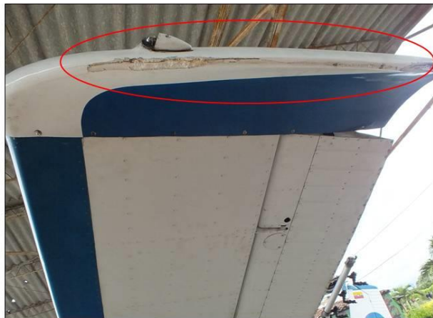
Rotura en montante y punta del plano izquierdo
