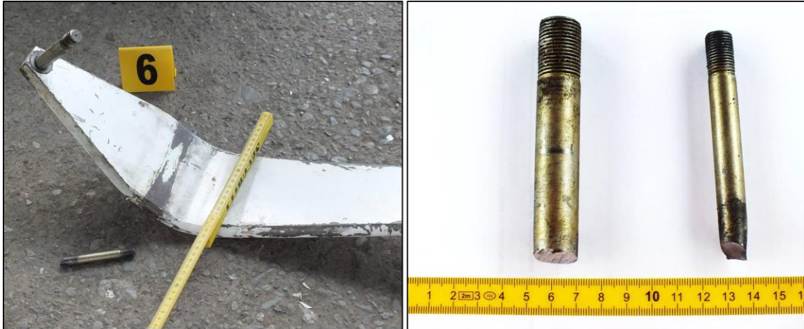
Fractura por impacto en los pernos de sujeción del tren de aterrizaje izquierdo
