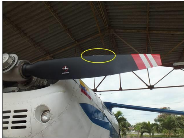
Abolladura en el capó inferior del motor y ralladuras en la hélice
