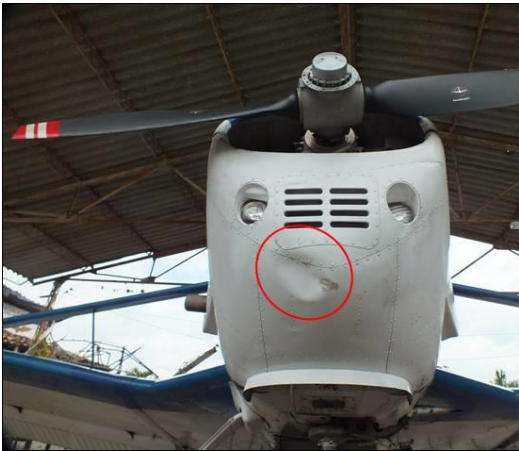
Abolladura en el capó inferior del motor y ralladuras en la hélice
