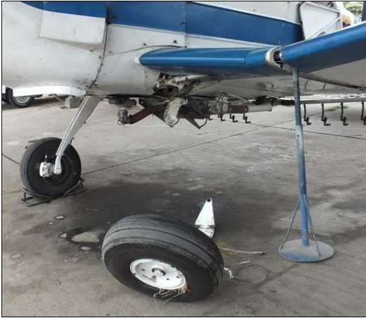
Daños en la pierna del tren de aterrizaje izquierdo
