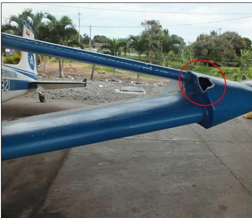
Rotura en montante y punta del plano izquierdo
