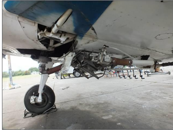
Daños en la pierna del tren de aterrizaje izquierdo
